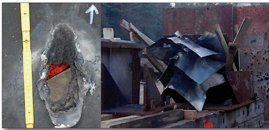
Пробој APFSDS – PELE на челичну плочу дебљине 100 mm, под углом 60° у односу на вертикалу (лево) и дејство иза те плоче на сведок-плоче (десно)
